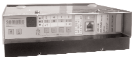
8 Fare eseguire un ciclo d'auto-apprendimento al controller del Sematic Drive System® (Rif. manuale 808-000-000). Detto ciclo deve essere effettuato accoppiando l'operatore ad una porta di piano. Fuori dalla zona di sbloccaggio delle porte di piano, il dispositivo impedisce l'apertura delle porte di cabina.
